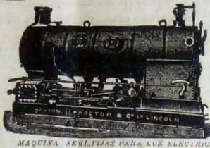
MÁQUINA SEMI-FIJA PARA LUZ ELÉCTRICA.
